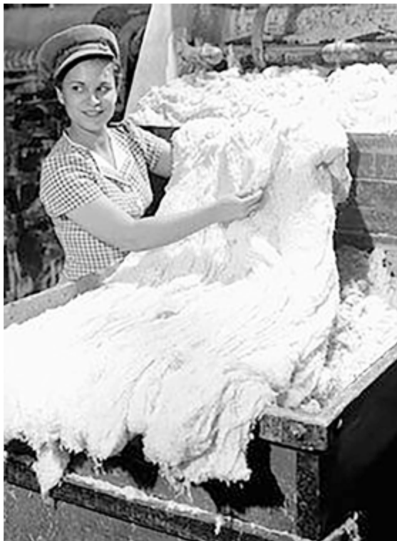
Operatrice che lavora con fibre di amianto senza nessuna protezione; le norme di medicina del lavoro erano ancora carenti. La foto è stata scattata in Canada fine anni '40.
